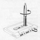
Um den Bandwickel zu lösen, das Band einmal schnell vor- und zurückspulen. Musik-Cassetten vor direkter Sonneneinstrahlung oder unmittelbarer Wärmeeinwirkung schützen. Verformungen und Schwergängigkeit werden dadurch vermieden.
