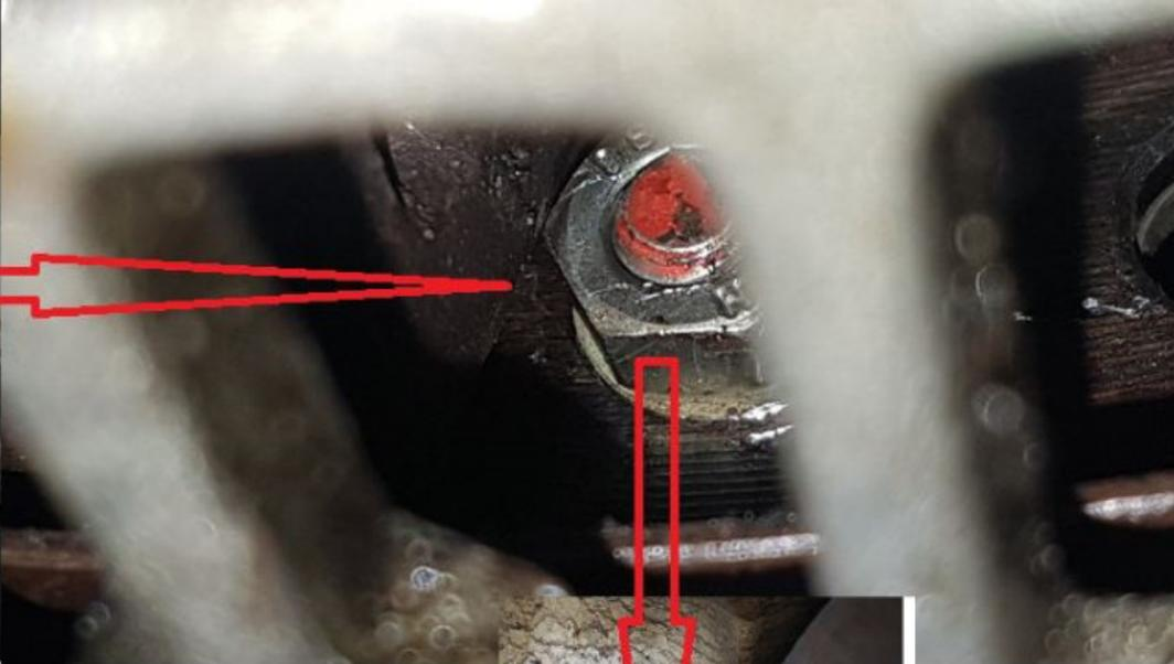
Muss beim Anflanschen des Getriebes, korrekt positioniert sein. Die Mutter bzw. das Gewinde der Schraube (rot) lässt sich nicht an der Wandlerbefestigung vorbeiführen.
