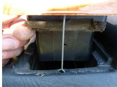
Die Zugstange für die Feder aussen. Einhängen, bevor man die Leisten einbaut, danach kommt man nicht mehr dran!
