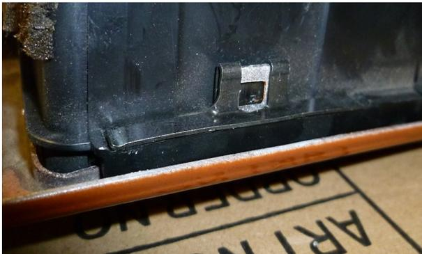
Das sind die Klammern, mit denen die Luftdüsen auf die Zierleiste geklemmt werden.
